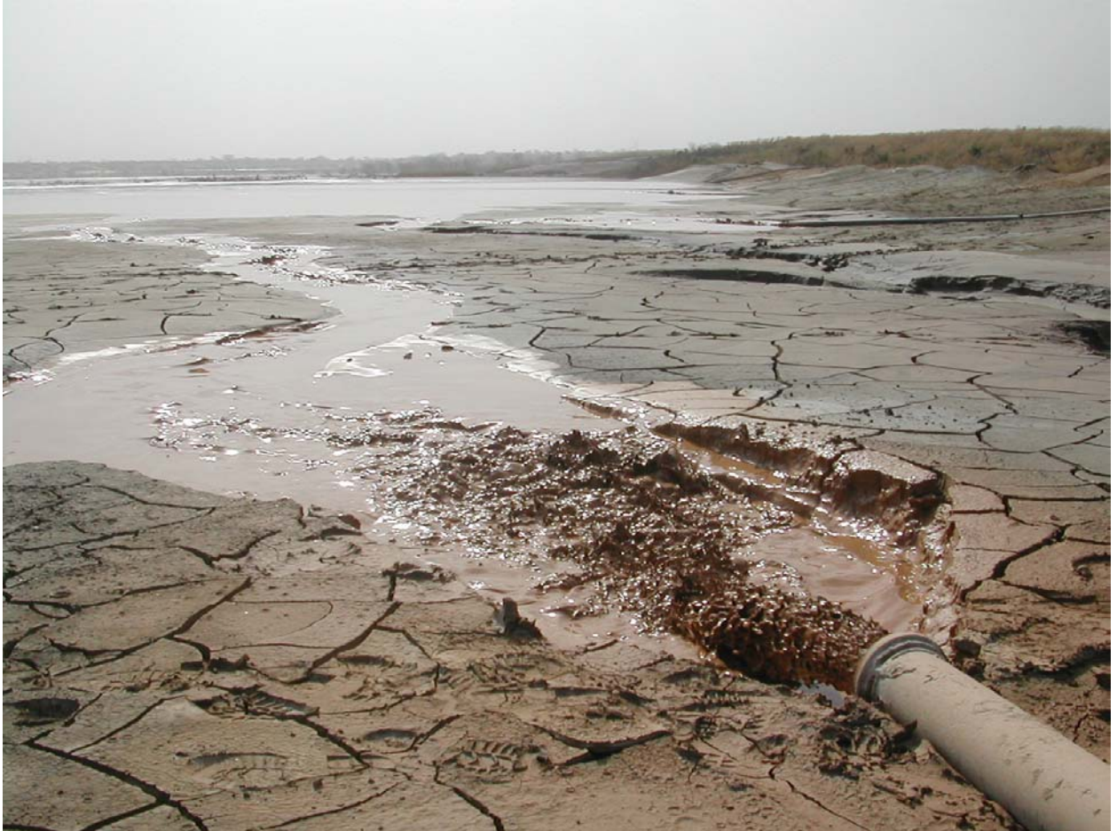
Déversement des boues cyanurées, slime dam
