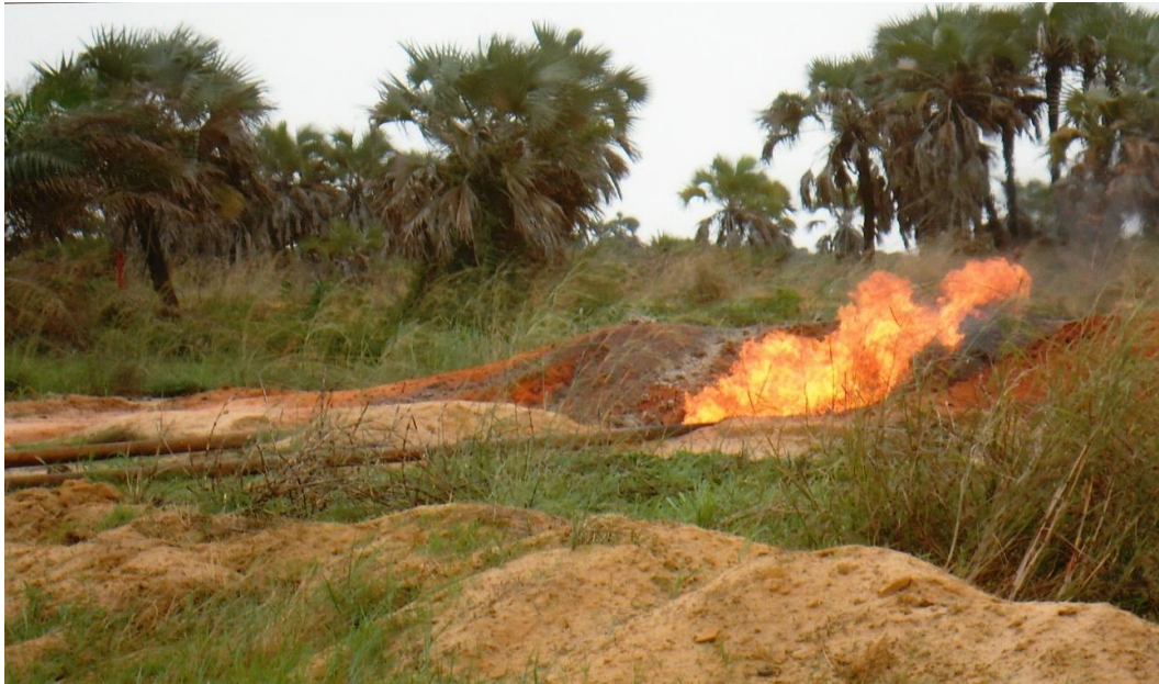
Photo n°1 : torchage à ras le sol
