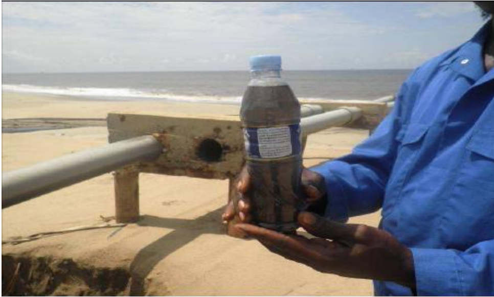
Photo n°31 et 32 : Prélèvement d'échantillon au lieu du déversement de l'effluent final dans l'océan : l'effluent final rejeté à l'océan est chargé d'hydrocarbures 19,20
