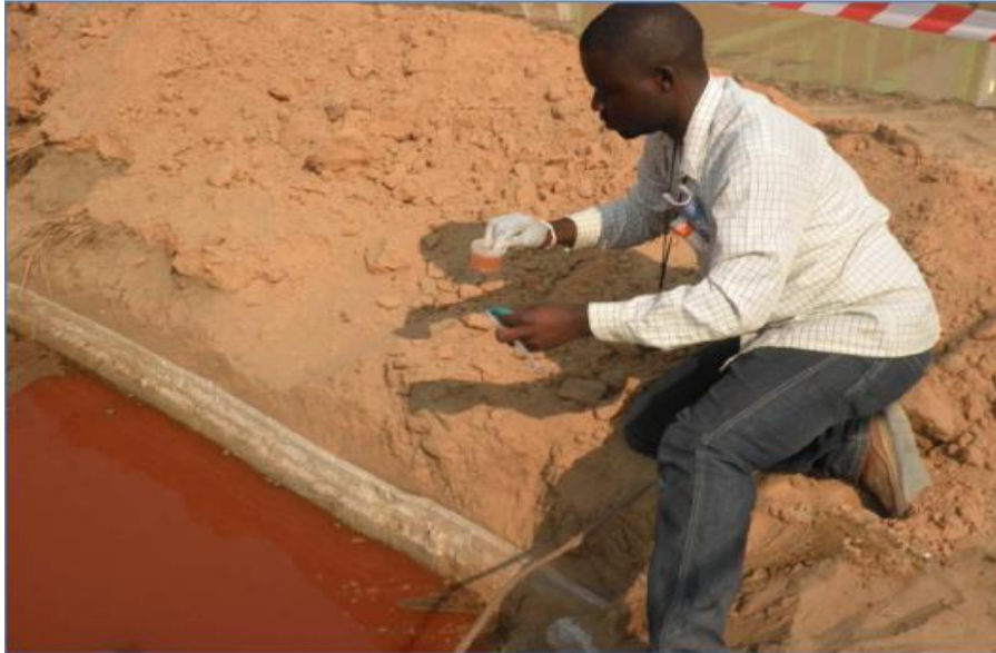
Photo n°34 : prélèvement d'échantillons dans une fosse d'enfouissement de la boue de forage 22
