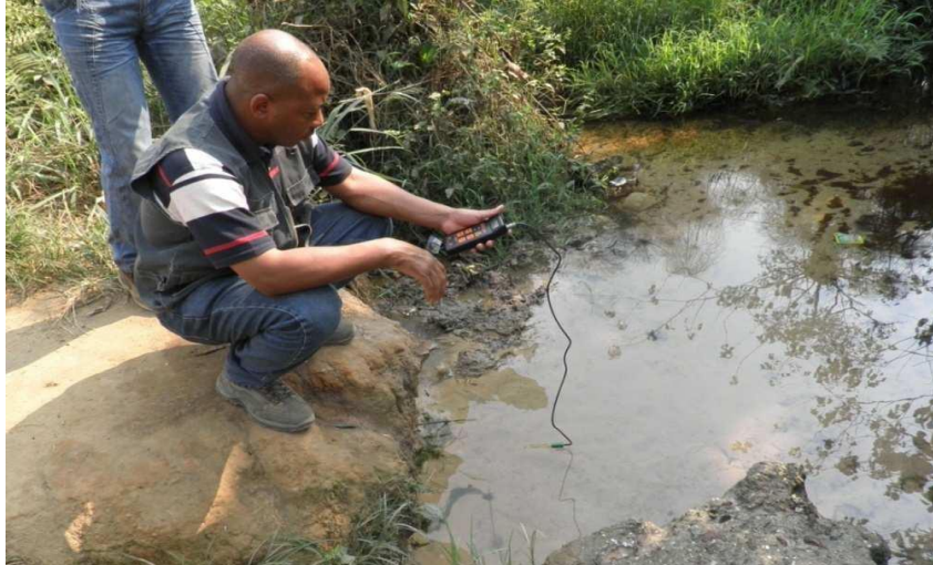
Photo n°66 : mesure in situ de la qualité de l'eau de rivière 54
